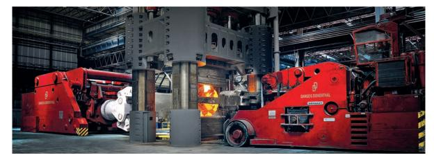
Die schienengebundenen Schmiedemanipulatoren mit einem Eigengewicht von 900 Tonnen und einer Traglast von über 250 Tonnen bei der Arbeit.
